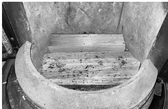
Abb. 4.2.2 Holzaufgabeart bei Nennwärmeleistung
